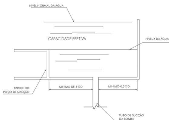
Figura B.3 – Tomada Inferior de sucção para bomba principal
