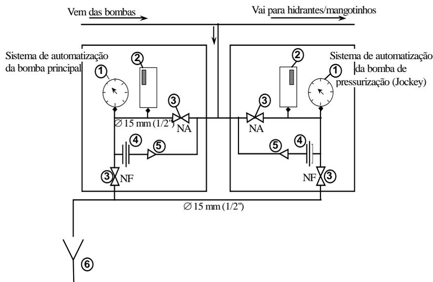
Figura C.2 – Cavalete de automação das bombas principal e de pressurização
