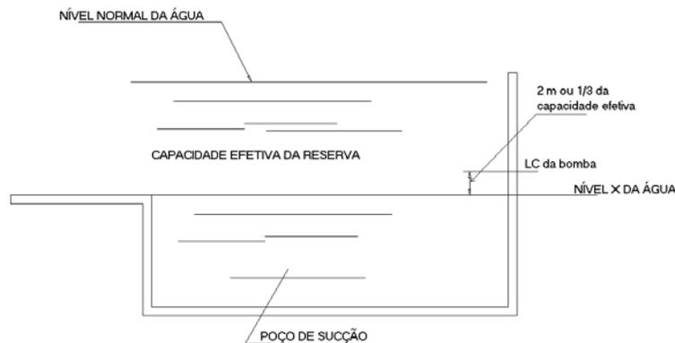
Figura C.1 – Condição positiva de sucção da bomba de incêndio
