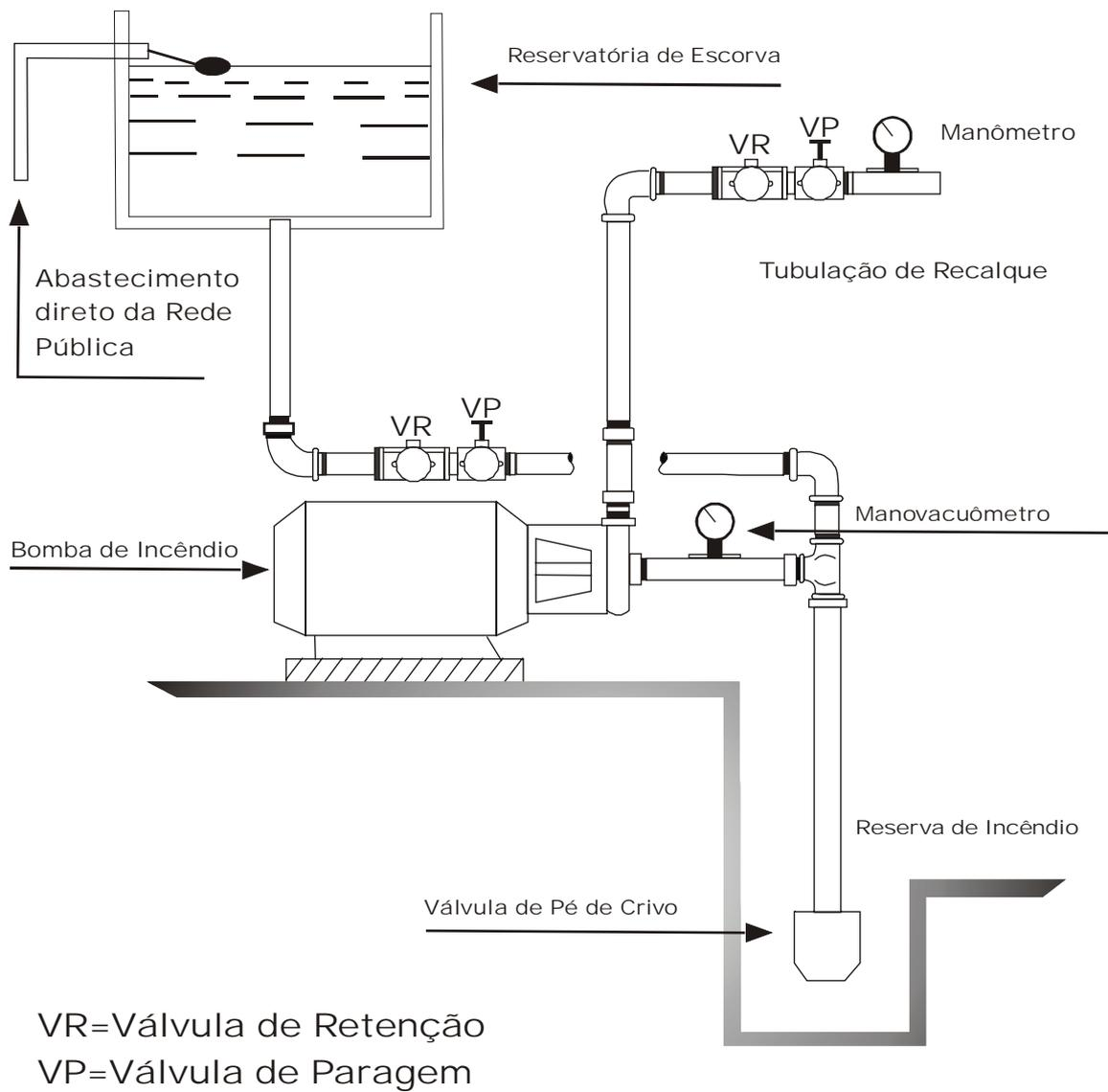
Figura C.3 – Exemplo de afogamento de bomba de incêndio
