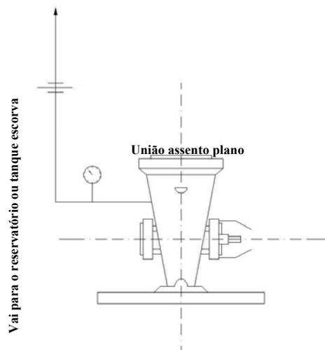
Figura C.6 – Arrefecimento da bomba principal elétrica
