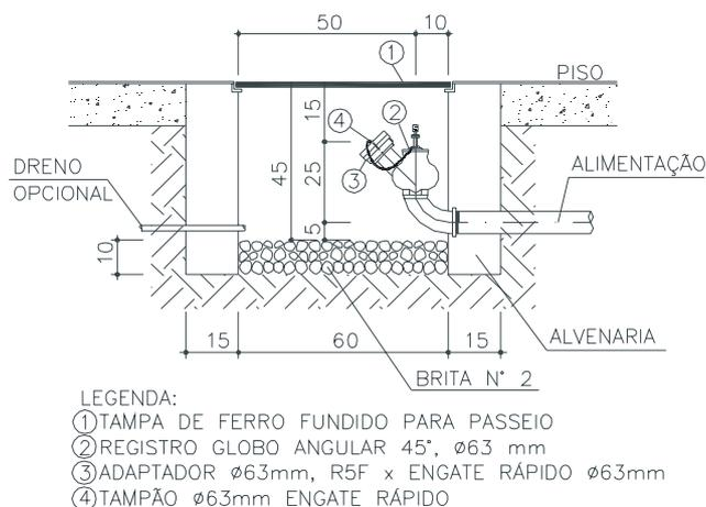
Figura 1 – Dispositivo de recalque no passeio público
